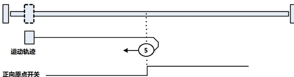
原点开关位于机械正方向。机械往原点开关方向运动，当检测到原点开关后减速停止，再反转退出原点开关，找原点开关信号下降沿位置记录为原点，电机立即停止。
