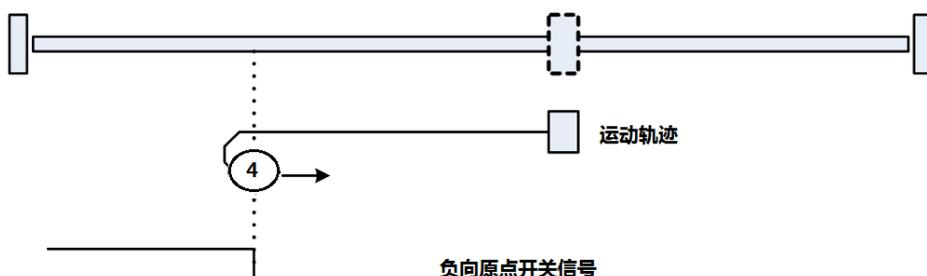
原点开关位于机械负方向。机械往原点开关方向运动，在检测到原点开关后减速停止，再反转退出原点开关，找原点开关信号下降沿位置记录为原点，电机立即停止。
